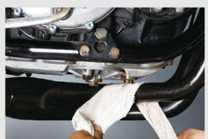
③オイル交換およびオイルフィルター交換が可能な集合マフラーを取り付けていたが、エンジンオイルの排出栓にエキパイを汚してしまったため、エキパイをしっかり拭き取り脱脂した。
