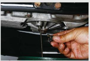
①オイル交換の都度、オイルフィルターを交換するのがベストだが、前回のオイル&フィルター交換から1000kmに満たない走行距離だったので、今回はオイル交換のみ実施した。ドレンプラグとフィルターケースのドレンを抜いた。
