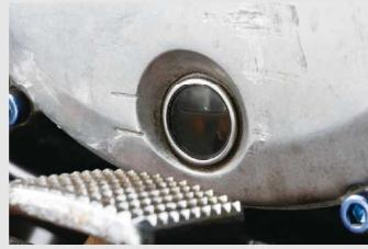
⑦エンジン停止直後ではなく1分程度待ってからレベル窓を確認し、不足している分だけエンジンオイルを補給する。アッパーレベルのラインを超えてはいけない。吹き返しの原因になる。
