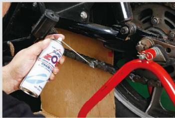
⑧シールチェーンを洗浄する際には「シール対応の洗浄液」を利用しよう。一般的なバーツクリーナーではNGだ。ここではスーパーゾイル・チェーンクリーナーを利用した。しっかりと振ってから吹き付けよう。このチェーングリスはシールチェーン対応だ。試運転後のチェーンが温かいときに施工するのがベストである。
