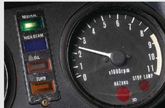
⑤エンジン始動直後から空吹かしのではなく、アイドリング+a程度の回転域を保持してエンジンオイルがひとまわりするのを待つ。1分程度オイルを回したらエンジンを停止する。
